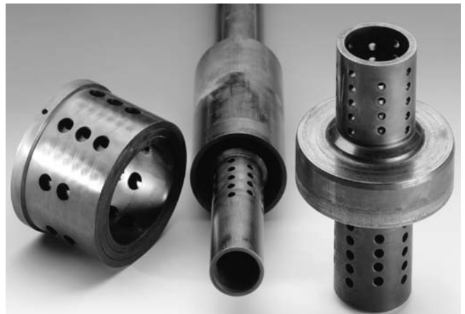
Innenteile eines Mindestmengenregelventils ZK 213, DN 100 nach 13 Jahren Betrieb p_1 = 374 bar, p_2 = 11 bar, t = 172 °C, m = 35 kg/s
